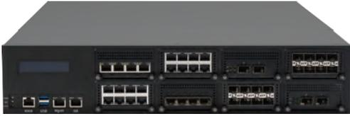
K2731A는 Intel® 2<sup>nd</sup> Generation Xeon Scalable Processor를 탑재한 고성능 Network Appliance Server입니다. 최대 2개의 CPU로 최적의 성능을 발휘합니다.
